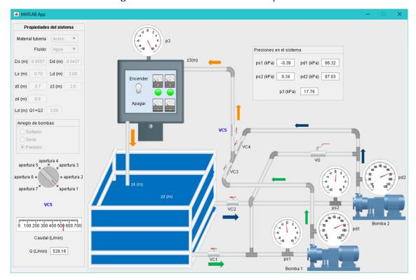
Figura 10. Procedimiento C: sistema en paralelo
