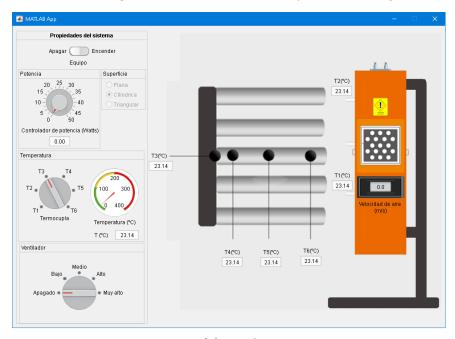
**Figura 6**. Aplicación desarrollada (derecha) de la práctica de convección forzada y natural con la geometría de aletas cilíndricas
