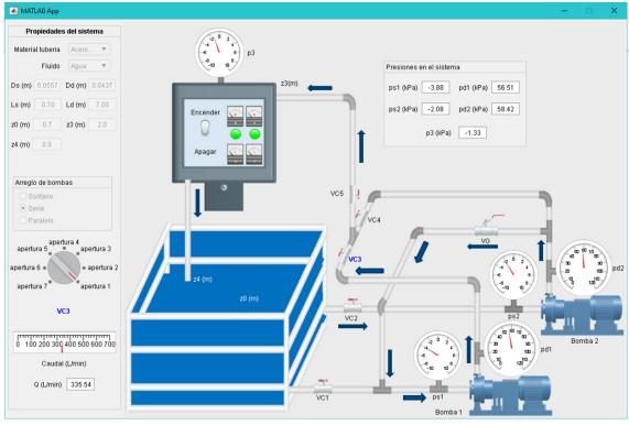
Figura 9. Procedimiento B: sistema en serie
